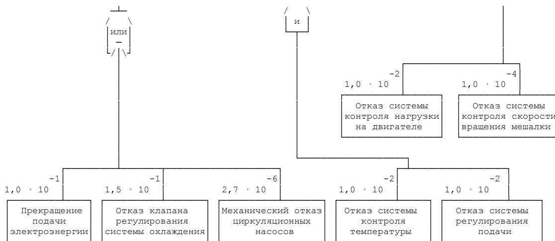
Рис. 8-1. Пример дерева отказов для химических реакторов
